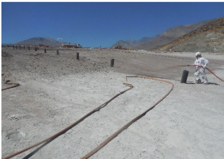
Ilustración 4 Registro fotográfico de segunda prueba de aplicación de supresor de polvo (2)
